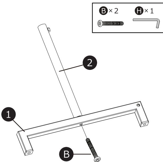
2 ①で組み立て脚部に③脚部フレームを取り付けます。このとき、ボルトはきつく締めずに仮止めしてください。
