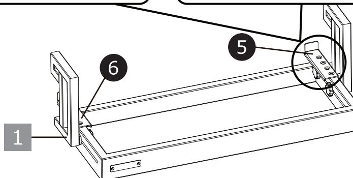
3 ②で組み立てたフレームに①プレートをのせます。
