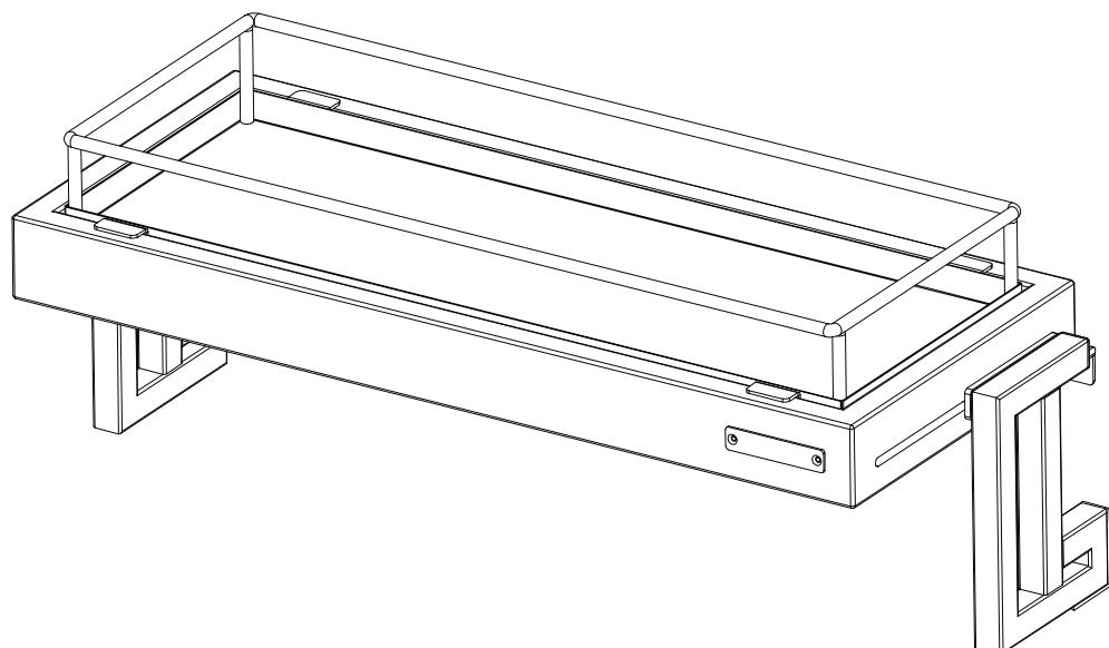
③脚部（左）・④脚部（右）に貼り付けてある滑り止めには、保護フィルムが貼り付けてあります。本製品をご使用になる際は、**保護フィルムを剥がしてからご使用ください。**
